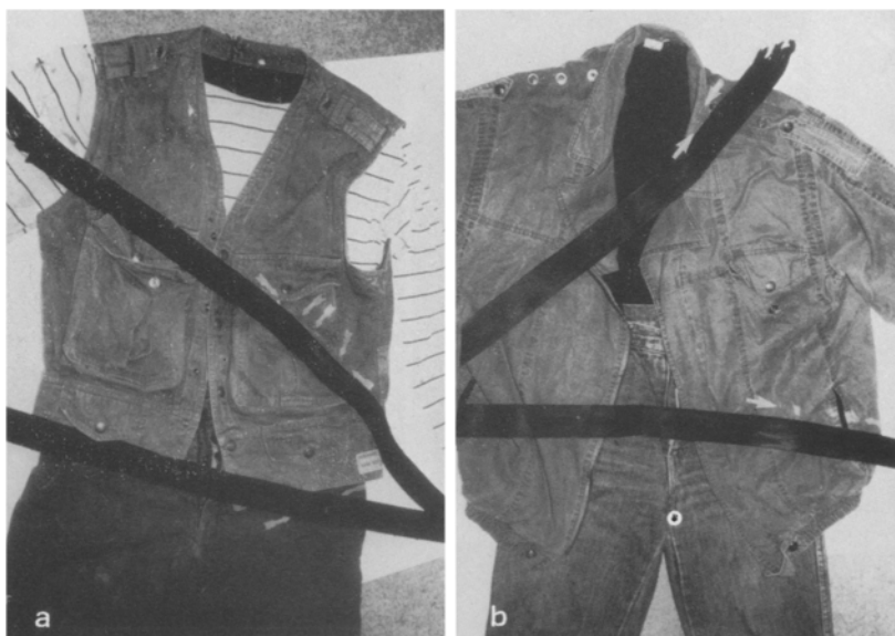
Abb. 4. a Die Rekonstruktion des Gurtverlaufs weist den Träger dieser Kleidung als Beifahrer aus. b Die Rekonstruktion des Gurtverlaufs weist den Träger dieser Kleidung als Fahrer aus. Die weißen Pfeile markieren Textilgewebsveränderungen (Schmelz- und Schürfspuren)
